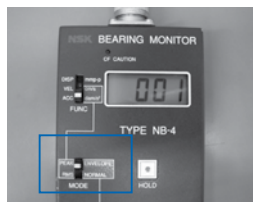
Записывание вибраций, вызванных царапиной внутри подшипника (ENVELOPE)
