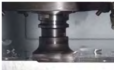
Торцевая фреза: \phi 80 Обрабатываемый материал: S50C Частота вращения: 1 200 об/мин 504 см 3 /мин
