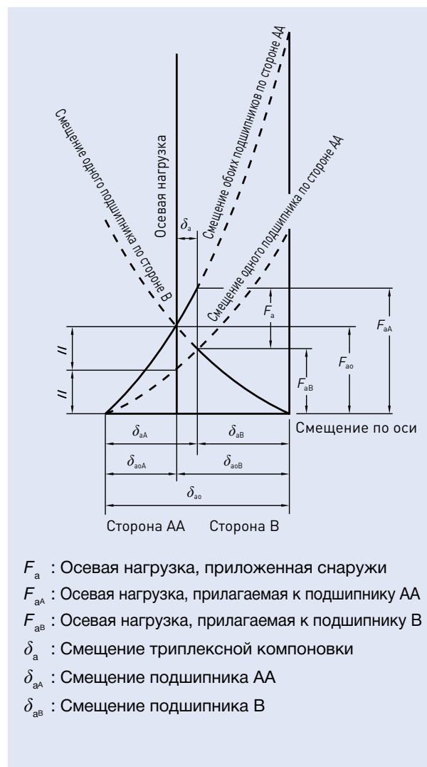
Рис. 4.6 Смещение по оси компоновки DBD с преднатягом
