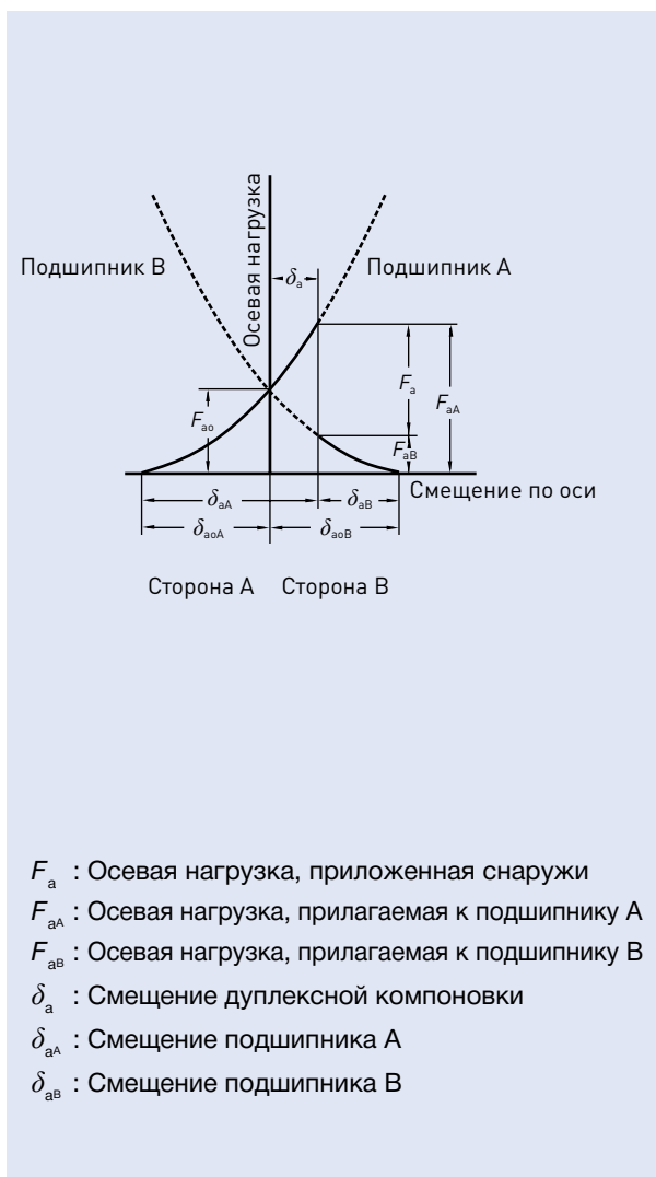
Рис. 4.4 Смещение по оси компоновки DB с преднатягом
