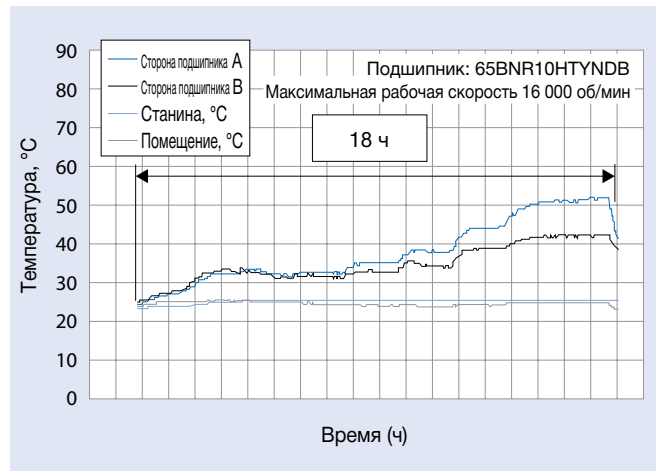
Рис. 3.1 Изменения температуры при работе с постоянной скоростью
