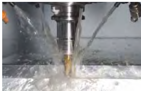
Концевая фреза: \phi 16 Обрабатываемый материал: A5052 Частота вращения: 20 000 об/мин 2 500 см 3 /мин
