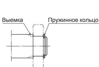
(a) Пружинное кольцо и заплечик с выемкой
