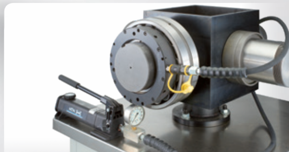
Извлечение стяжной втулки с помощью гидравлической гайки
